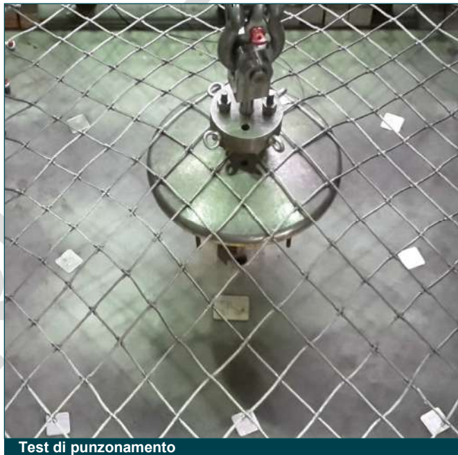
Test di punzonamento
