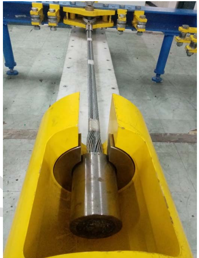
Fig. 1: Test di trazione dell'ancoraggio T-FAST
