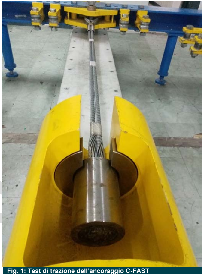
Fig. 1: Test di trazione dell'ancoraggio C-FAST
